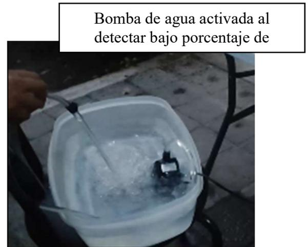
Nota: En la figura 6 se aprecia cómo se activa la bomba de agua cuando el sensor detecta una disminución de humedad menor al 20% y como se desactiva al detectar una humedad superior al 55%. Fuente: Propia.
