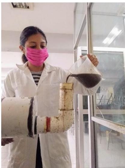
**Figura 7. Alimentación de biodigestor semicontinuo**
