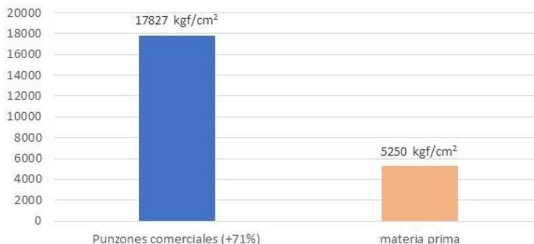
La tabla 7 junto con la gráfica 2, demuestra los promedios de dureza de las diferentes secciones de la herramienta de sujeción contrapunto con un valor de 50 RC que representa 247,000 PSI que también significa 17,290 kgf/cm<sup>2</sup> con un rango de lecturas en el equipo de 2 RC y una variabilidad alrededor de la media de 1 RC o bien 78,000 PSI o 5,460 kgf/cm<sup>2</sup>.
