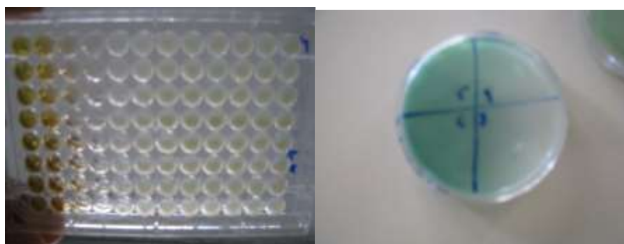
Figura 4. Micro dilución en placa para CMI y prueba CMB de Pseudomonas syringae .
