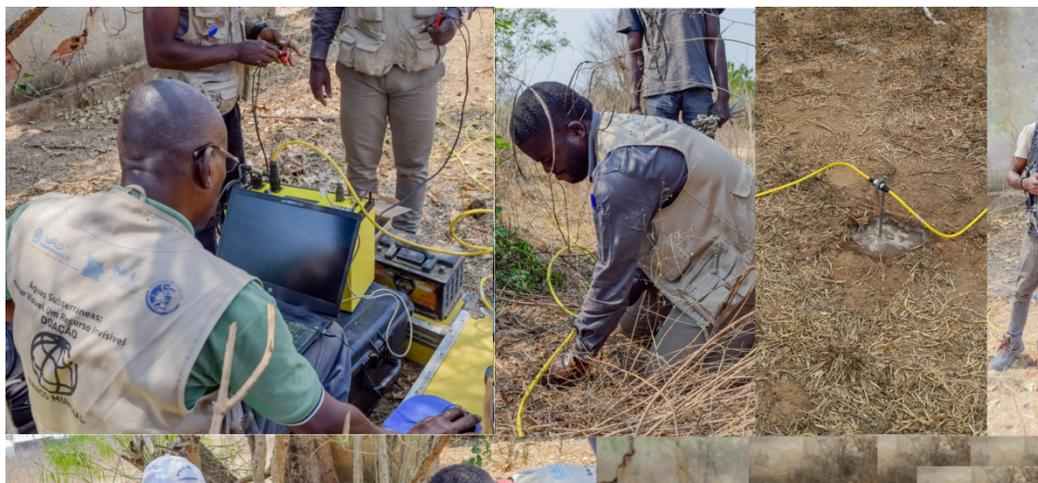
**Fig. 5 Resistímetro “SuperSting R8/IP/SP/WiFi+84 Resistivity Imaging System” e momentos de aquisição de dados em campo.**
