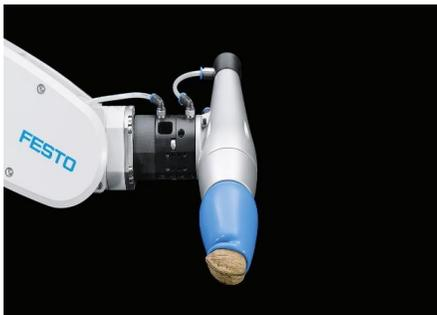
**Fig. 3 Brazo Robot con mordaza de succión Fuente: Festo**
