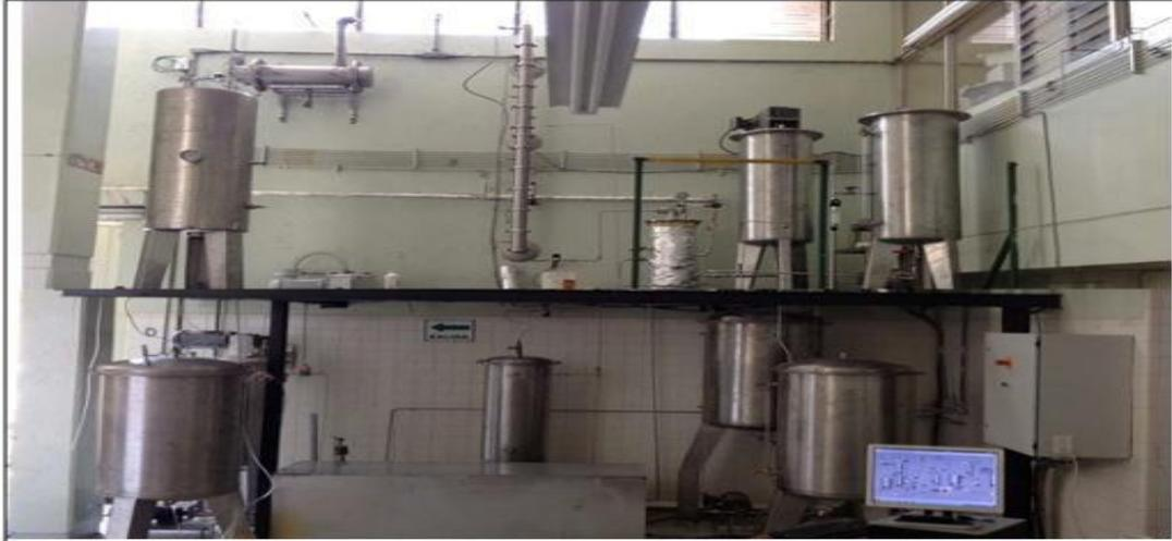
Figura 5.21. Planta piloto procesadora de biodiesel a partir de *Jatropha curcas*.
