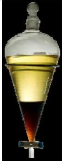
Figura 5.16. Biodiesel y glicerina típicos productos de reacción de transesterificación.
