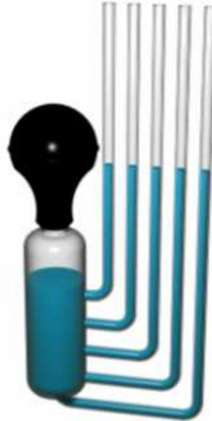
Dilatómetro: Coeficiente de dilatación lineal de un sólido
