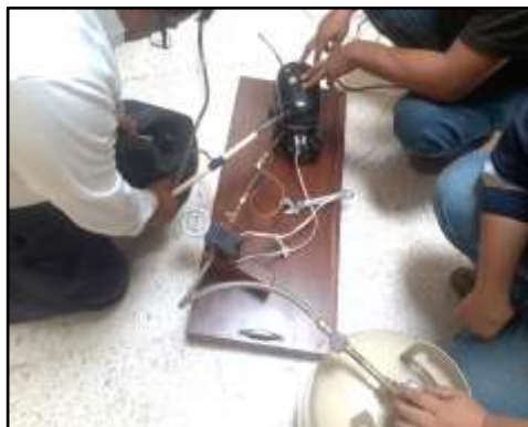
Imagen 2. Acoplamiento de los componentes del sistema de compresión de biogás
