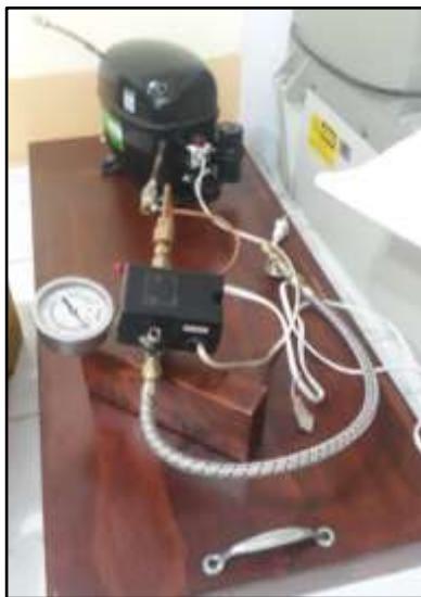
Imagen 3. Sistema de Compresión de biogás
