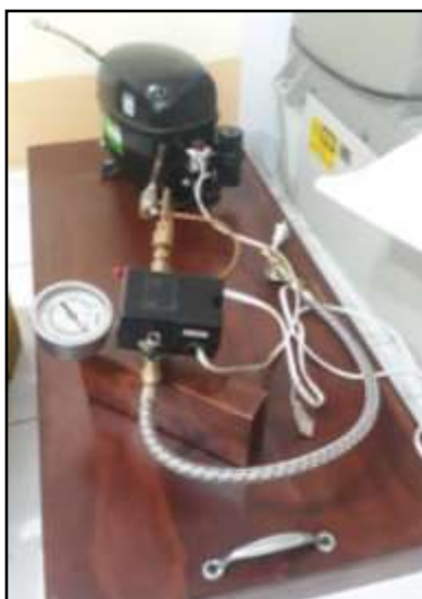
Imagen 3. Sistema de Compresión de biogás
