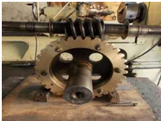
Figura 2. Elaboración Tornillo sin fin- Corona. TALLERES CEMI.
