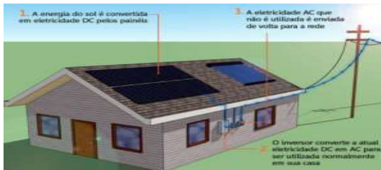
Figura 3 – Sistema de captação e consumo de energia elétrica (CA).
