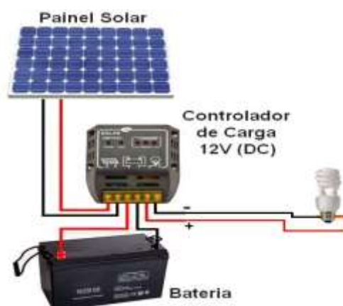
Figura 4 – Processo de obtenção e consumo de energia elétrica (CC).
