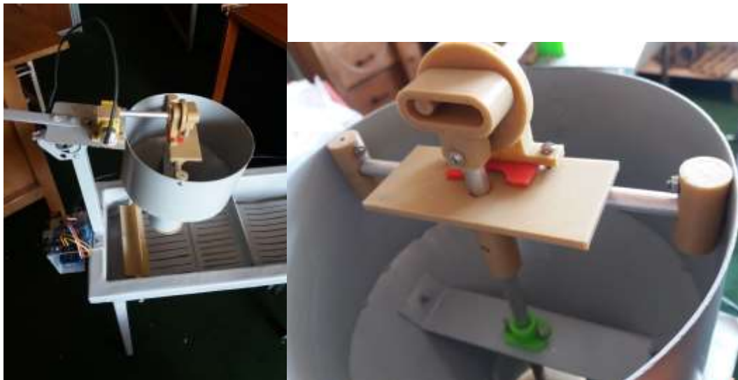
Figura 24. Máquina prototipo para elaboración de donas
