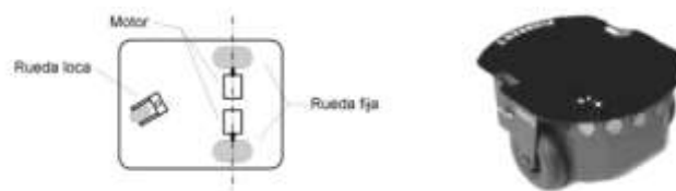
Fig. 1: Sistema de tracción diferencial (Hernández Martha, Miguel, and Joaquín n.d.).
