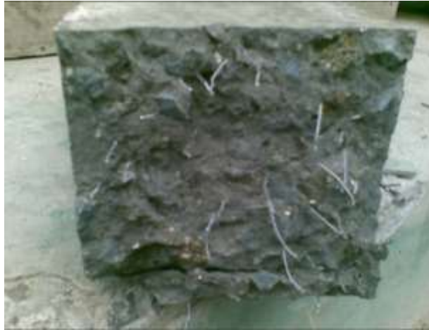
Figura 6. Falla a flexo tracción del hormigón reforzado con fibras
