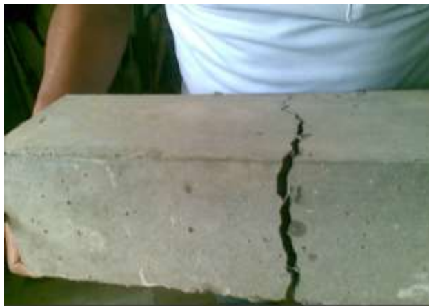
Figura 5. Falla a flexo tracción del hormigón convencional
