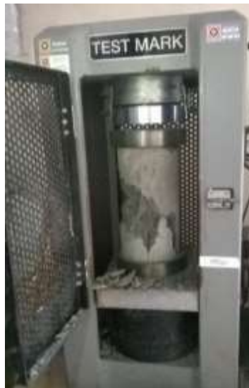
Figura 2. Tipo de falla a compresión del diseño de hormigón convencional.
