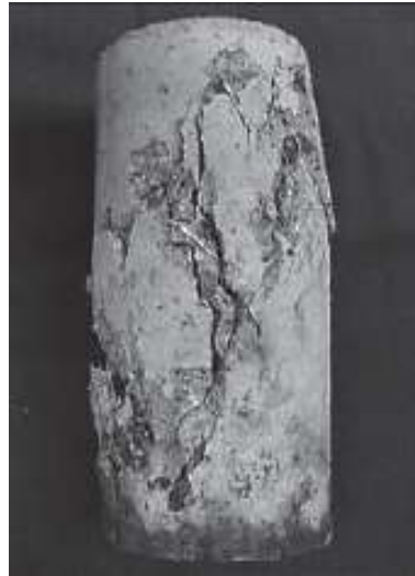
Figura 3, Tipo de falla a compresión del diseño de hormigón fibroreforzado
