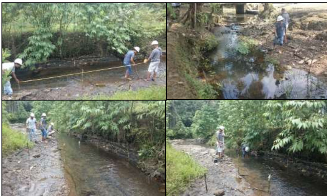
Figura 4. Medición de caudal de 3 cuerpos de agua dentro del área de implantación del proyecto. (1, 2) Establecimiento de puntos de referencia; (3) Toma de tiempos; (4) Medición de área
