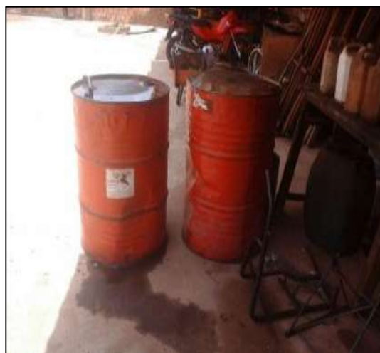
Figura 07- Tambor sem bacia de contenção
