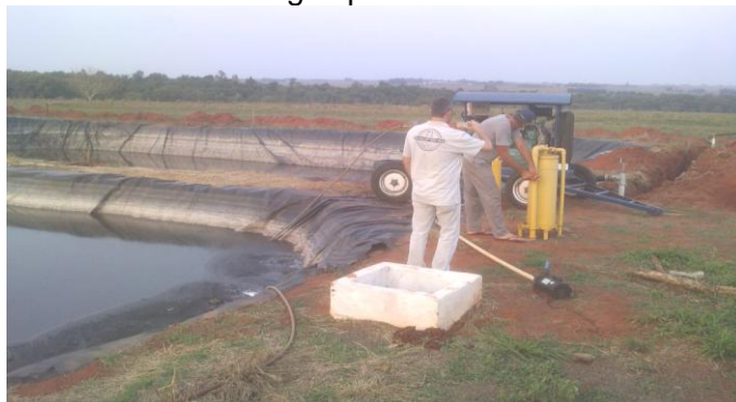
Figura 2 – Motobomba a biogás para bombear o biofertilizante líquido
