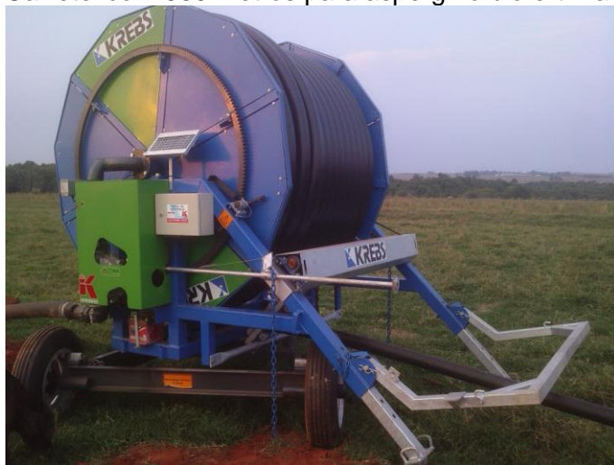
Figura 8 – Carretel com 350 metros para aspergir o biofertilizante líquido
