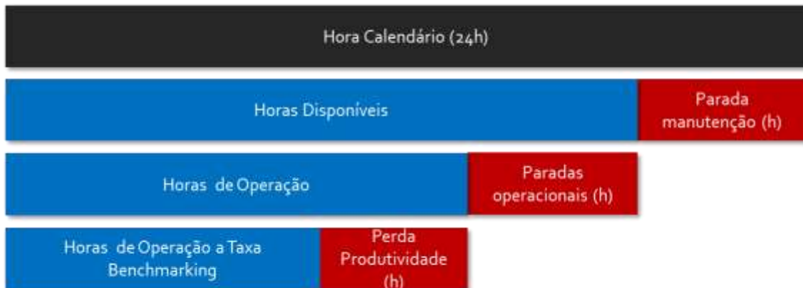
Figura 6. Esquema do OEE adaptado
