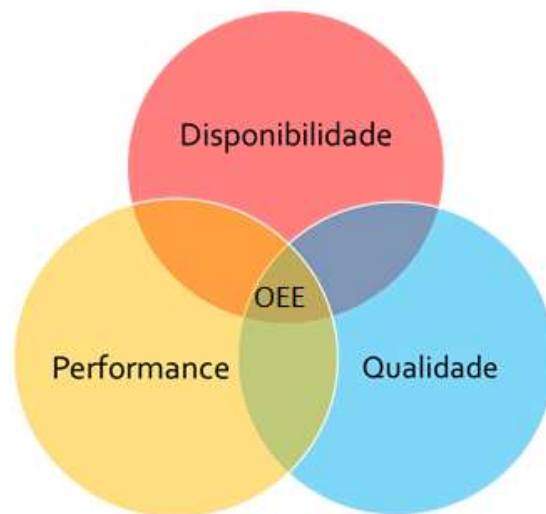
Figura 2. Representação das dimensões da OEE
