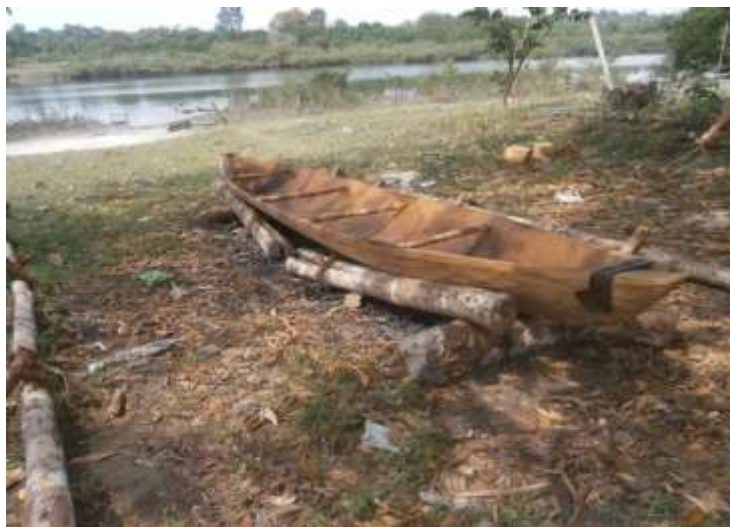
Figura 11: Casco em processo final de construção.
