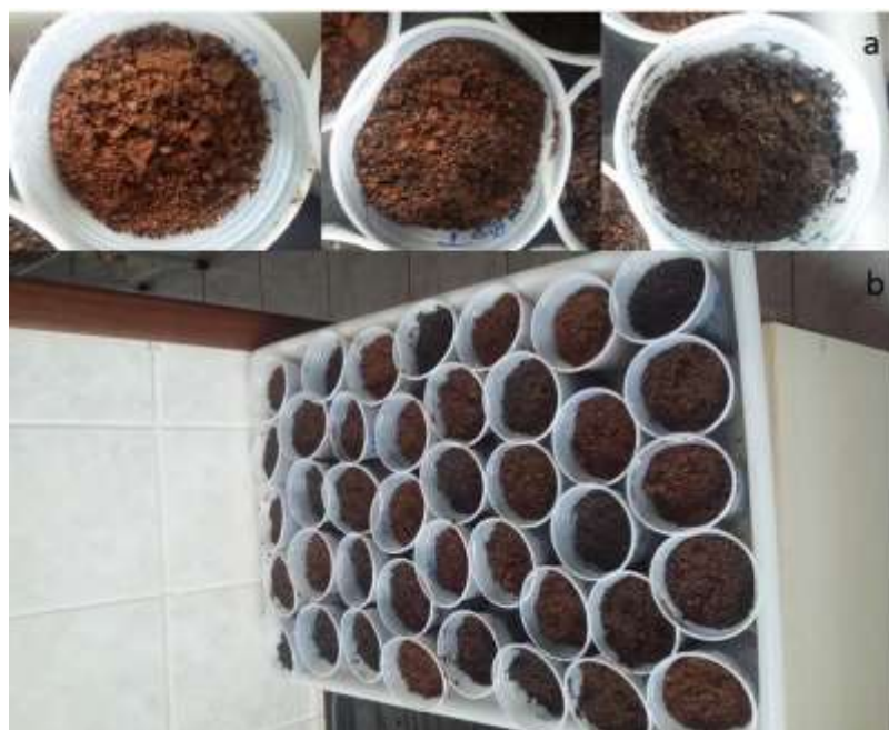
Figura 2. a) detalhes dos copos preenchidos com diferentes concentrações de lodo de esgoto. b) Experimento montado em copos utilizando a espécie Anadenanthera macrocarpa .
