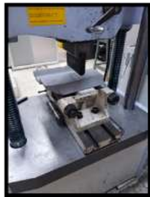
Ilustración 3: Ensayo de flexión en teja 2 Fuente: Propia Elaborado: Karen Lozano
