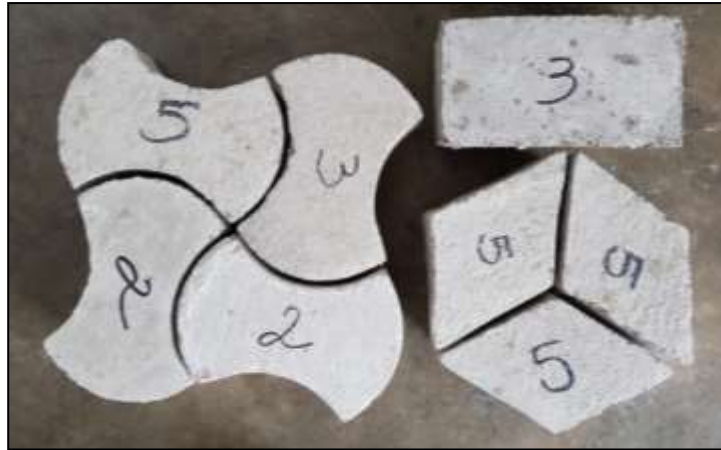
Ilustración 2: Diferentes diseños con las mezclas de los adoquines Fuente: Propia
