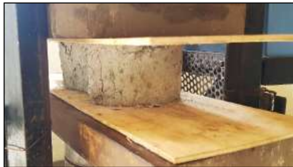
Ilustración 5: Ensayo de compresión en adoquín 5
