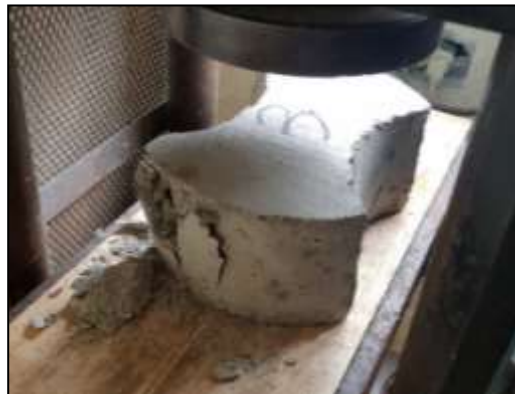
Ilustración 3: Ensayo de compresión en adoquín 3 Fuente: Propia
