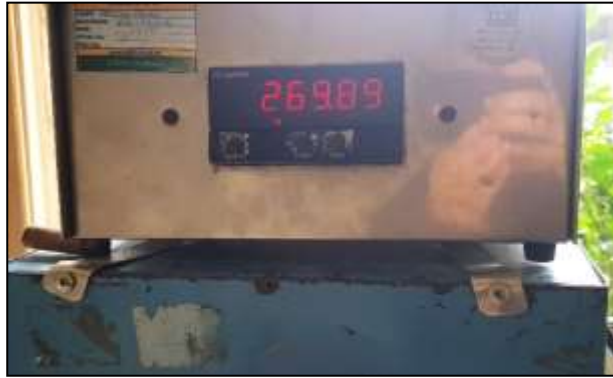
Ilustración 4: Resultado de ensayo de compresión en adoquín 3
