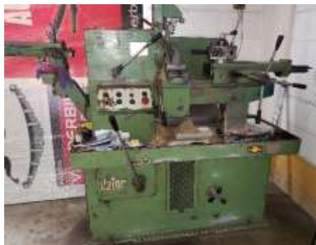
Figura 3: Torno revolver para trabajos varios en bronce
