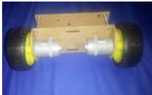
Figura 3. Chasis del robot de balance.
