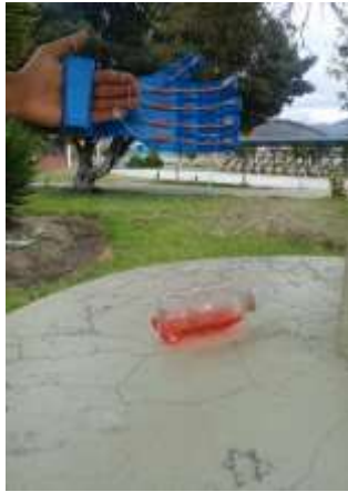
Gráfico 9. Descripción: Cuerpo de 500 gramos suspendido en el aire por acción del brazo mecánico, el cual mantiene su fuerza de 40 Newtons.
