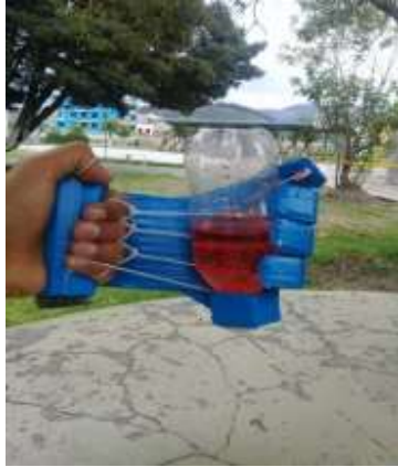
Gráfico 9. Descripción: Cuerpo de 500 gramos suspendido en el aire por acción del brazo mecánico, el cual mantiene su fuerza de 40 Newtons.
