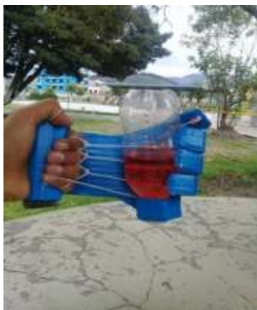
Gráfico 8. Descripción: Cuerpo de 500 gramos suspendido en el aire por acción del brazo mecánico, el cual aplica de una fuerza de 40 Newtons sobre el mismo.
