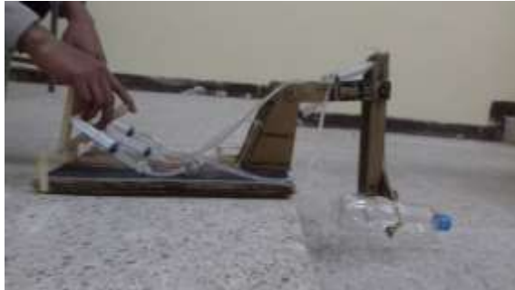
Gráfico 12. Descripción: Aplicación de la fuerza de 40 Newtons sobre el sistema hidráulico-mecánico, el cual levanta un cuerpo de 500 gramos por acción de dicho sistema con fuerza determinada y una presión en jeringuillas de 353,677 pascales.
