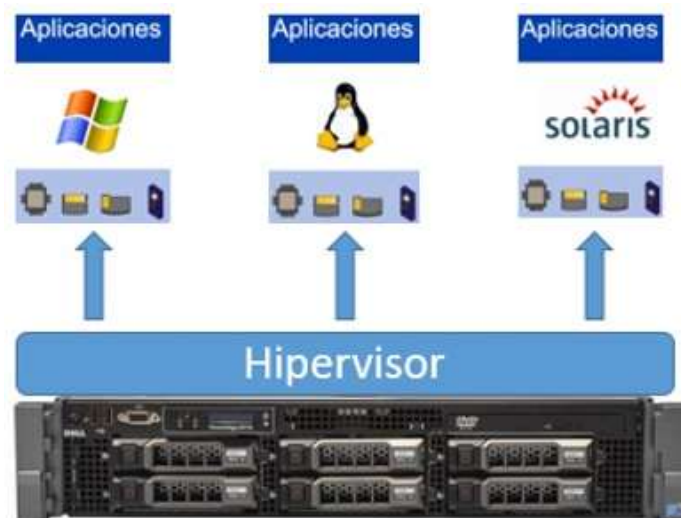
Figura 2. Esquema general del funcionamiento de la virtualización
