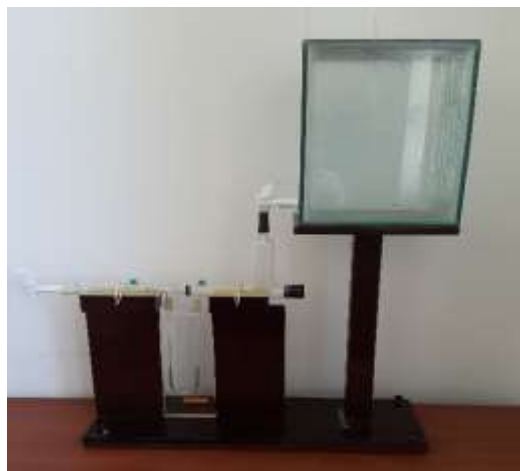
Figura 04.- Modelo de tubo de Venturi construido y utilizado en esta investigación
