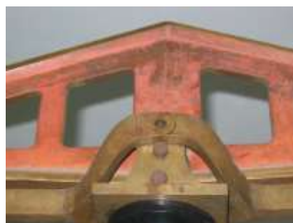
A la izquierda; deterioro por uso en borde superior de aceitera. A la derecha; abrasión de capa pictórica, probablemente por problemas de adherencia al metal en copete de báscula de formato mediano
