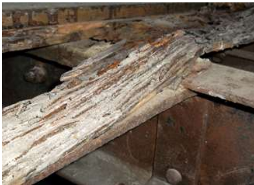
Fig. 1. Degradación de material altamente higroscópico (madera), frente a degradación de metal, la imagen muestra diferentes velocidades de deterioro. Fig. 2. Dos materiales distintos conforman un mismo bien, en este caso, los materiales reaccionan al tiempo de diversa manera.
