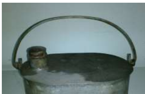
A la izquierda; deterioro por uso en borde superior de aceitera. A la derecha; abrasión de capa pictórica, probablemente por problemas de adherencia al metal en copete de báscula de formato mediano
