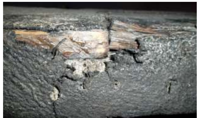
Fig. 1. Degradación de material altamente higroscópico (madera), frente a degradación de metal, la imagen muestra diferentes velocidades de deterioro. Fig. 2. Dos materiales distintos conforman un mismo bien, en este caso, los materiales reaccionan al tiempo de diversa manera.
