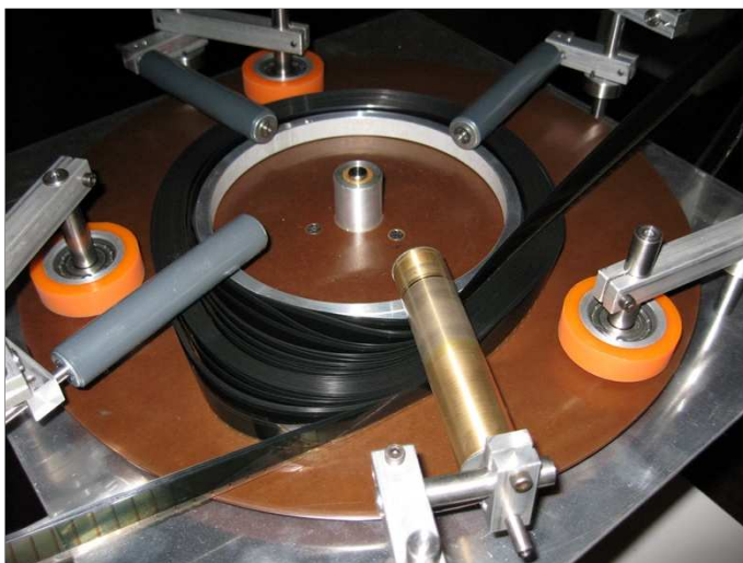
Fig. 5. Formato de la película To Pour a Milk Into a Glass, de D. Lamelas, C. J. Guerrero, 2009. En la imagen se puede observar el funcionamiento del proyector con la película dilatada por efecto del calor y el uso. Fuente: la autora.
