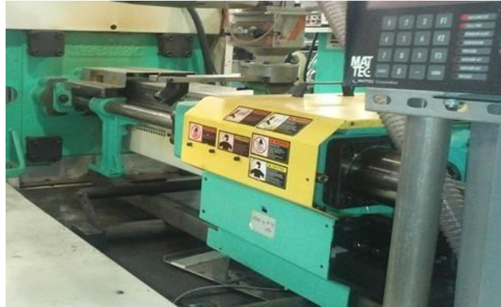
Figura No. 7. Unidad de inyección (fundidora).
