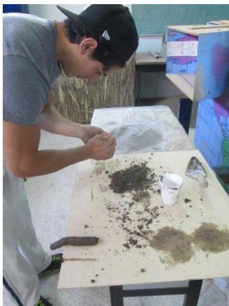
Elaboración de mezcla con tierra arcillosa
