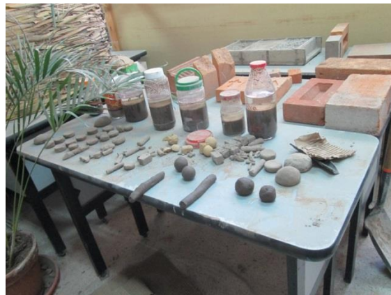
Pruebas con esferas, churros y sedimentación
