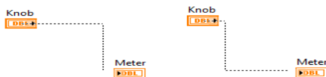
Figura 17: Diferentes caminos que puede tomar el cableado.
