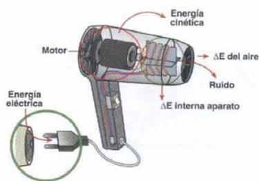
Fig. 1.2. En un secador de pelo la energía eléctrica se transforma en otros tipos de energía, como la cinética del aire impulsado, la acústica, y, sobre todo, el aumento de energía interna (aumento de temperatura) del aire.
