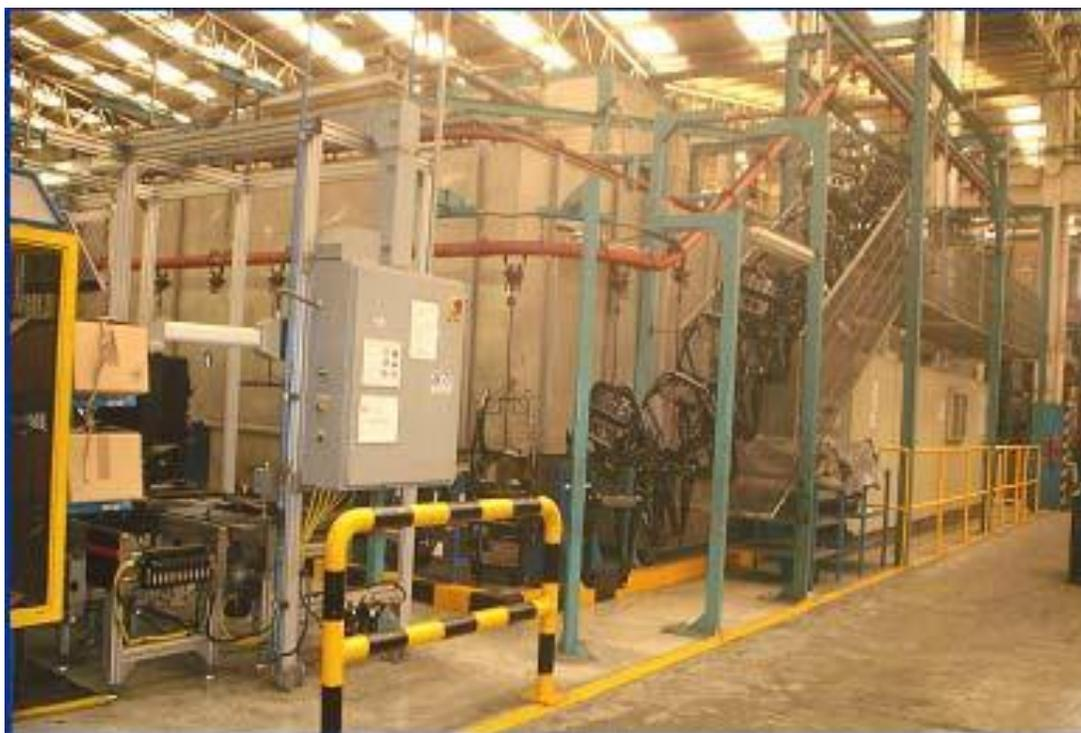
*Figura 1.6. Carrusel con ganchos para la línea de pintura.*
