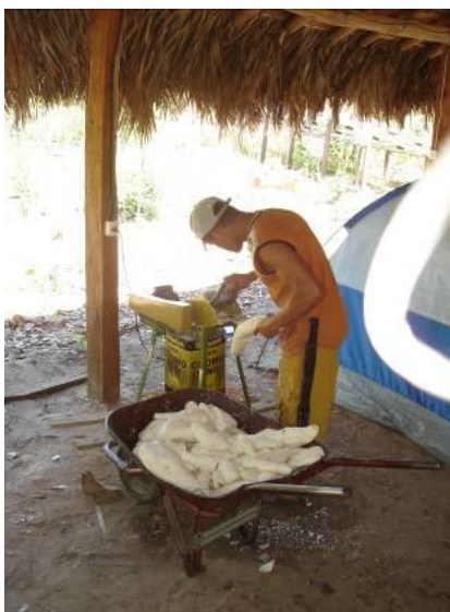
Figura 05: Máquina de Ralar Mandioca para Produção de Farinha Instalada na Oficina Comunitária
