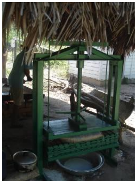
Figura 06: Prensa para Casa de Farinha Utilizada para Extrair Água da Massa e Aumentar o Rendimento do Processo Tanto em Tempo Quanto em Massa.
