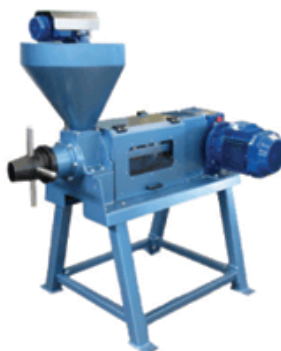
Figura 09: Extrator Mecânico de Óleos. Fonte: ALVAN BLANCK, 2009
