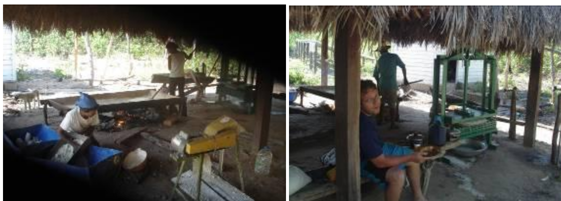
Figura 17: Casa de Farinha em Operação. Destaque para Prensa e Máquina de Ralar Mandioca.
