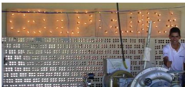
Figura 09: Painel de Lâmpadas para Teste de Carga.
