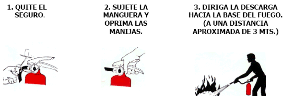
Fig.02 procedimiento para el uso de extinguidores.
