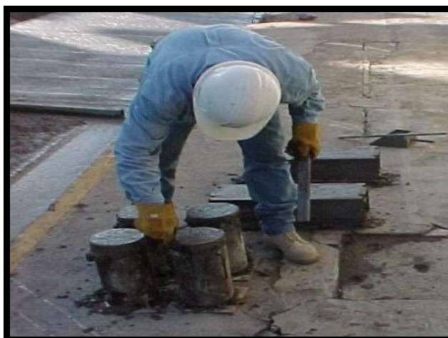
Foto 1. Elaboración de muestras de concreto
