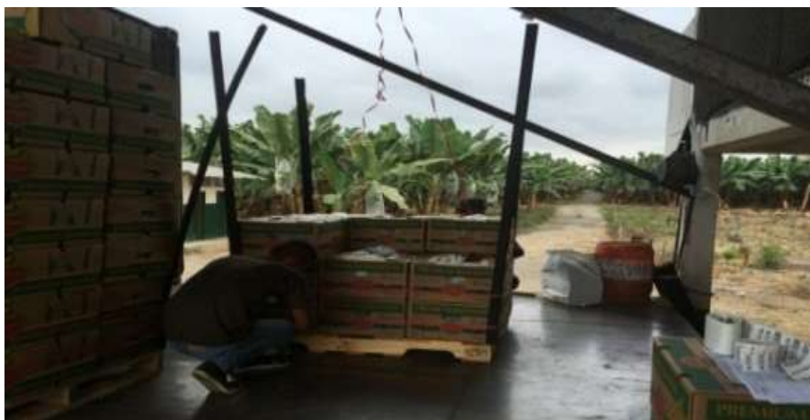
Ilustración 2. Personal asegurando los sunchos y esquineros con el uso de grapas
