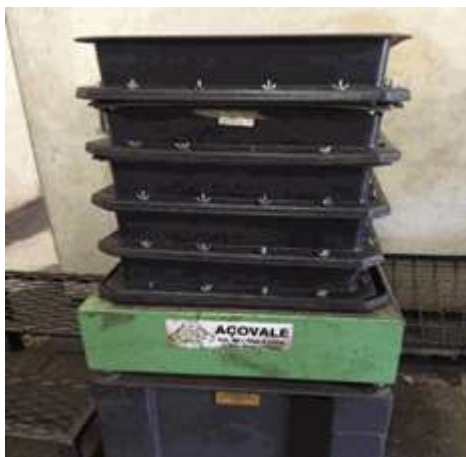
Figura 10 - Conjunto de peneiras para análise granulométrica
