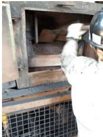
Figura 8 - Processo de retirada das amostras na tremonha de finos do Stock House
