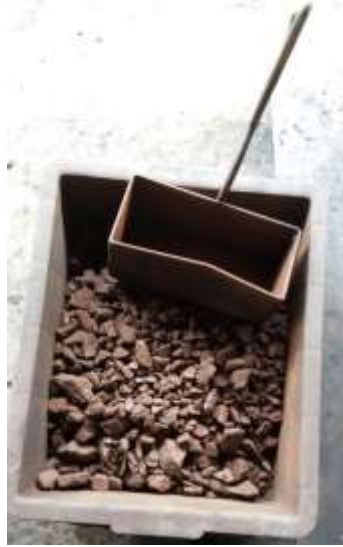
Figura 8 - Processo de retirada das amostras na tremonha de finos do Stock House
