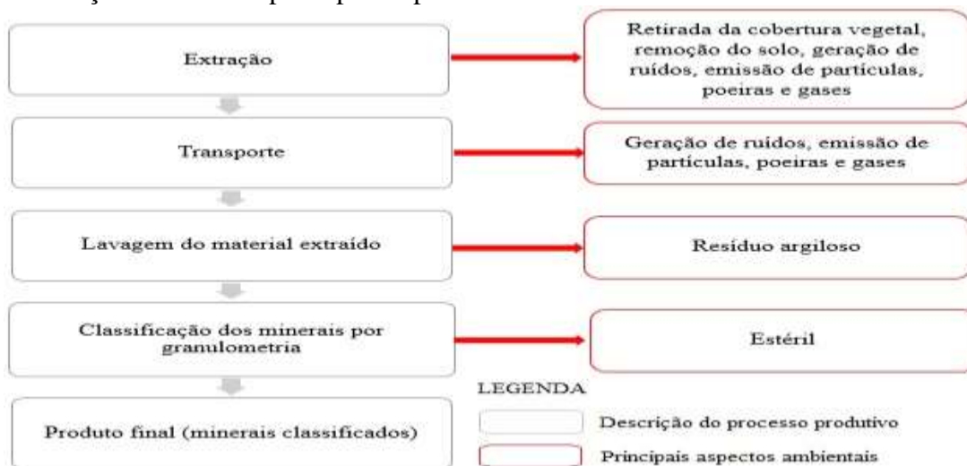
Figura 1: Descrição das principais etapas da cadeia produtiva dos agregados da construção civil e seus principais aspectos ambientais.
