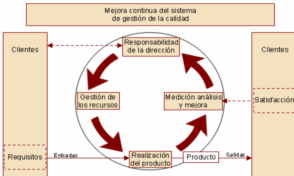
Figura 5. Modelo de un sistema de gestión de calidad basado en procesos
