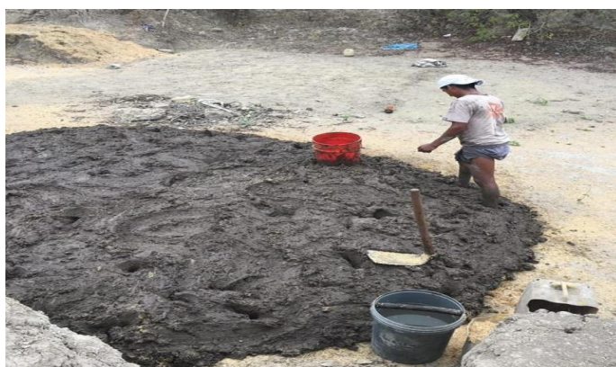
Figura 9. Mezcla utilizada para la fabricación de ladrillo (arcilla, tierra, aserrín y agua). Fuente: Fotografía de Vielka Zambrano, 2018.
