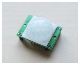
11 y 12. Placa Arduino y sensor de movimiento infrarrojo pasivo Pir
