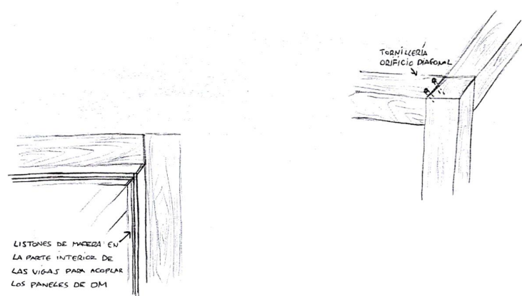
27. Detalle de la colocación de los tornillos y de los listones de sujeción en las vigas
