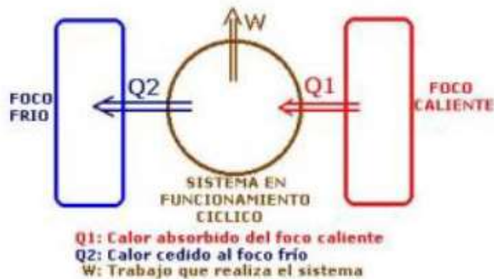
Figura 2. Sistema de funcionamiento de una máquina térmica Fuente: (Bravo Méndez, 2011)
