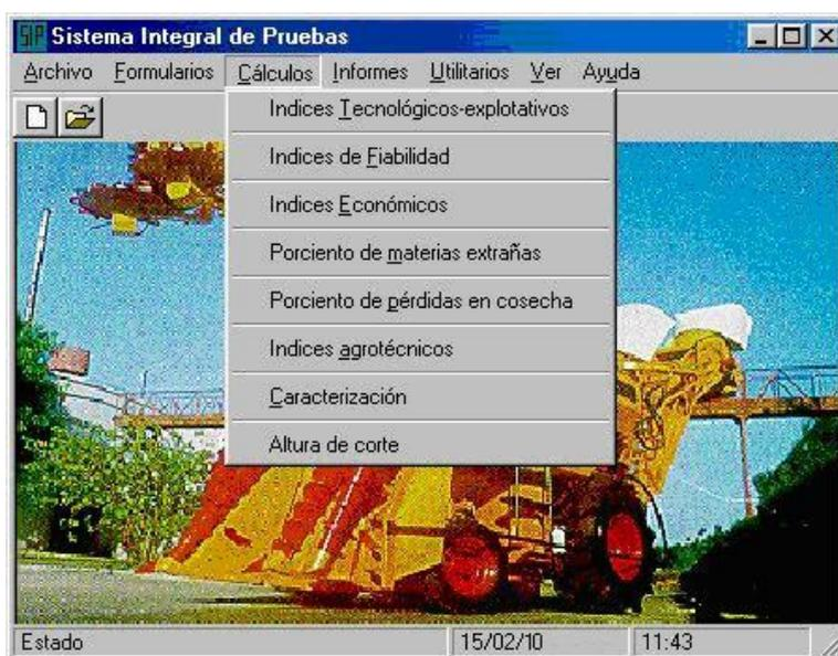
Figura 4. Pantalla del módulo de Cálculo de los diferentes índices del sistema.
