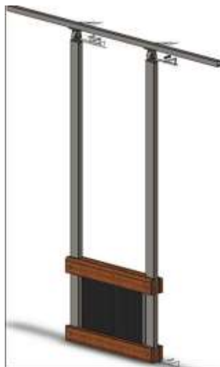
Figura 6. Sub-ensamble de batidora con peine.
