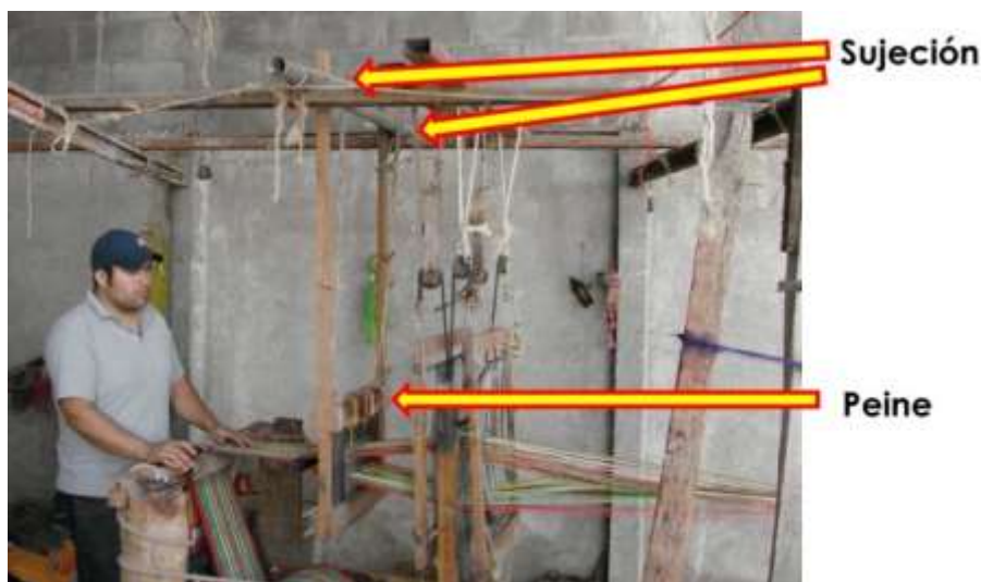
Figura 5. Sujeción de batidora con peine.
