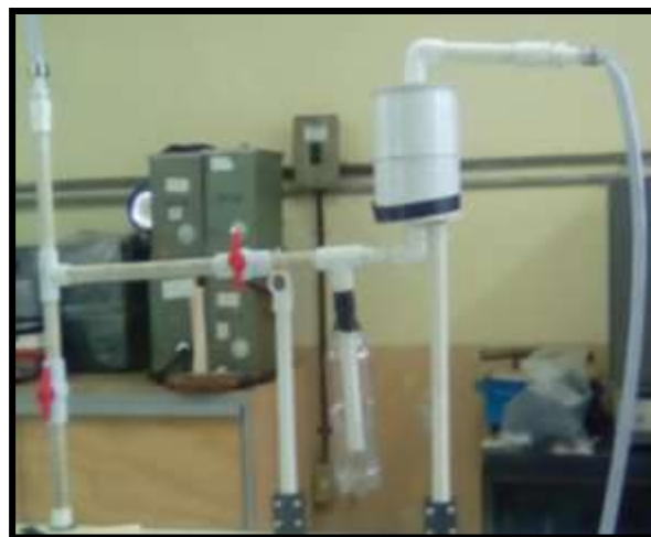
Ilustración 6 Trampa de agua y filtro de hierro para eliminar sulfatos y nitratos
