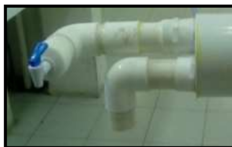
Ilustración 8 salidas de lodos y lixiviados
