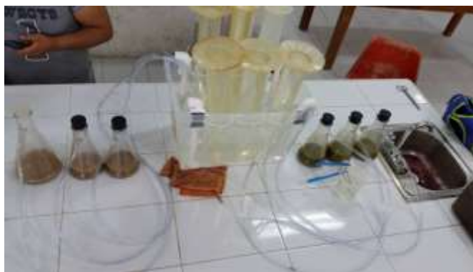
Figura 3. Biodigestor con matraces kitazato forma Erlenmeyer para pruebas a nivel laboratorio
