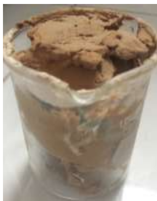
Figura 3.- Obtención del biopolímero del lactosuero. (Zárate Cruz, 2015)
